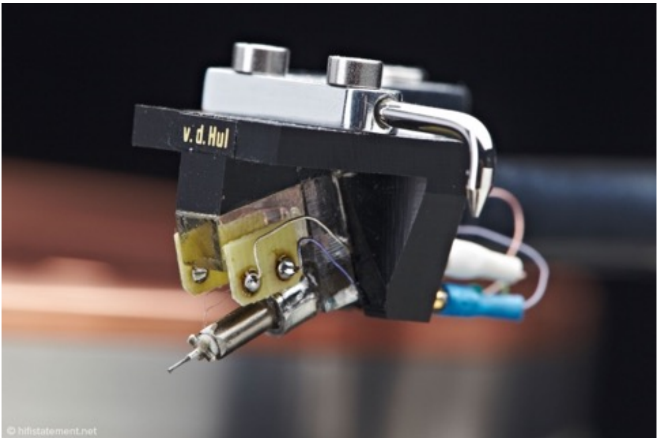
Das van den Hul Colibri Platinum mit dem charakteristischen grauen Spulendraht
